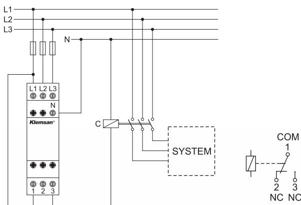
VP17 için iki fazlı ve tek fazlı sistemlerde kullanım şekli aşağıda gösterilmiştir. /
