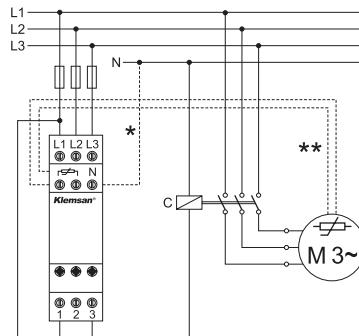
\* : Nötr girişi olan cihazlarda bu bağlantı yapılır / Should be connected for devices which requires neutral connection
