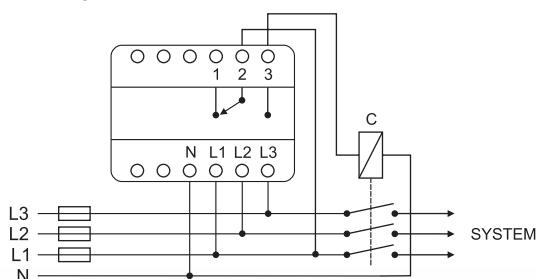
VP35 için iki fazlı ve tek fazlı sistemlerde kullanım şekli aşağıda gösterilmiştir. /
